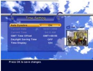
Automatische Synchronisation EIN: Die Aktuelle Zeit basiert auf der TDT (Time Description Table), welche durch das Signal des aktuellen Programms übertragen wird. Um die aktuelle Uhrzeit einzustellen, müssen Sie den Zeitversatz zur aktuellen Zeit, abhängig von Ihrem Standort einstellen. Diese Uhrzeit wird für den Elektronischen Programm Führer,
