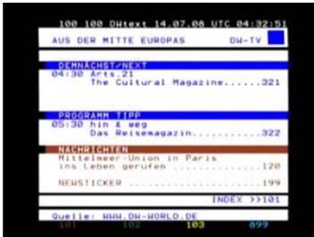
Der angezeigte Teletext basiert auf den übertragenen Daten nach EBU-Teletext-Standard und DVB-Bitmap. Teletext kann nur auf Fernsehern mit Teletext-Unterstützung angezeigt werden. Drücken Sie die TTX-Taste zum Benutzen des Teletextes. Sie erhalten das Hauptmenü (in der Regel Seite 100). Jedes Menü zeigt
