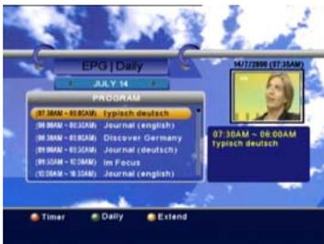
In diesem Modus werden alle Ereignisse des Tages angezeigt. Wählen Sie den gewünschten Kanal mittels der ▲, ▼ Tasten und den gewünschten Tag mittels der ▲, ▼ Tasten. Dann drücken Sie OK um die Ereignisse der Auswahl anzuzeigen. Nach einer kurzen Verzögerung wird die Programminformation aktualisiert. Wenn die Programminformation angezeigt wird wählen
