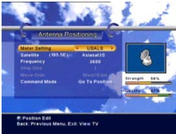
Dieser Modus erlaubt es Ihnen die Motorsteuerung durch DiSEqC 1.3 / 2.3 USALS (Universal Satellite Automatic Location System) vornehmen zu lassen.
