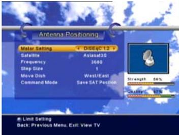
Dieser Modus erlaubt es Ihnen die Antenneneinstellung für jeden Satelliten vorzunehmen. Um die Antennen-Positionierung benutzen zu können müssen Sie einen Motor nach DiSEqC 1.2-Standard verwenden.
