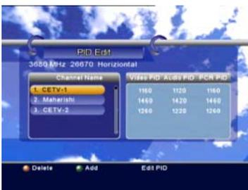
Verwenden Sie diese Option für bestimmte Transponder, welche keinen DVB-Standard-Kanal haben und welche nur gefunden werden, wenn Sie die notwendigen Einstellungen vornehmen. Hiermit können Sie auch Kanäle von einem Transponder löschen, oder hinzufügen.
