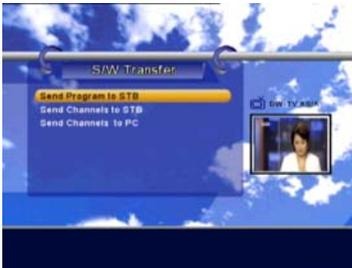
Die Firmware-Software in einem „Master-Receiver“ kann auf einen anderen „Slave-Receiver“ übertragen werden:
