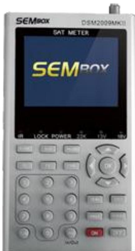
Das SEMBoX DSM2009 MKII Messgerät hilft Ihnen zuverlässig und effizient bei der exakten Ausrichtung und Inbetriebnahme von Satelliten-Spiegeln.
